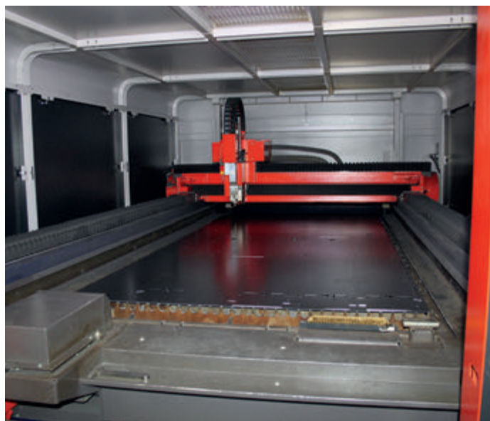
Arbeitsraum der BySprint 3015 mit dem eingefahrenen Wechseltisch und einer zur Bearbeitung aufgelegten Blechtafel.
