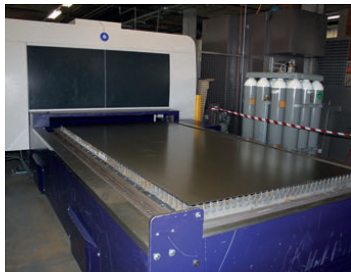
Be- und Entladebereich mit ausgefahrenem Wechseltisch zur Beladung mit einer Rohblechtafel; die sehr gute Zugänglichkeit an drei Seiten erlaubt die rationelle und Material schonende Beschickung beziehungsweise Teileentnahme mittels Vakuumhebergerät beziehungsweise auch manuell.
